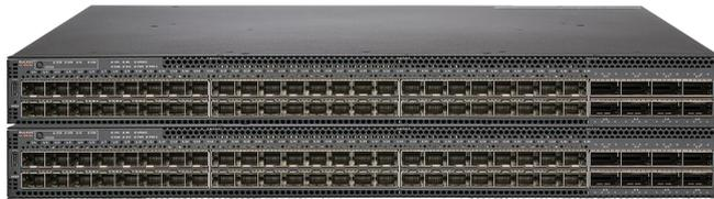
Ruckus® ICX® 7850 可堆栈汇聚交换机分为 1/10 GbE 和 1/10/25 GbE 机型。两款机型均为标准配置，带有 8 个 40/100 GbE 端口，用于堆栈或上行链路。1/10 GbE 机型可提供 48 个 1/10 GbE 端口，带有 MACsec 和 LRM 功能；1/10/25 GbE 机型可提供 48 个 1/10/25 GbE 端口和 8 个 40/100GbE 端口，用于上行链路或堆栈。这些交换机的目标客户是需要高性能、高可靠性汇聚/核心交换机或作为数据中心柜顶交换机的要求严苛的企业客户。
